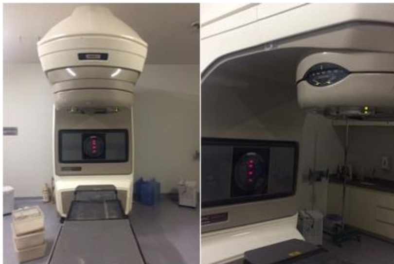
Figura 1: Acelerador linear Varian, modelo Clinac 600C.
